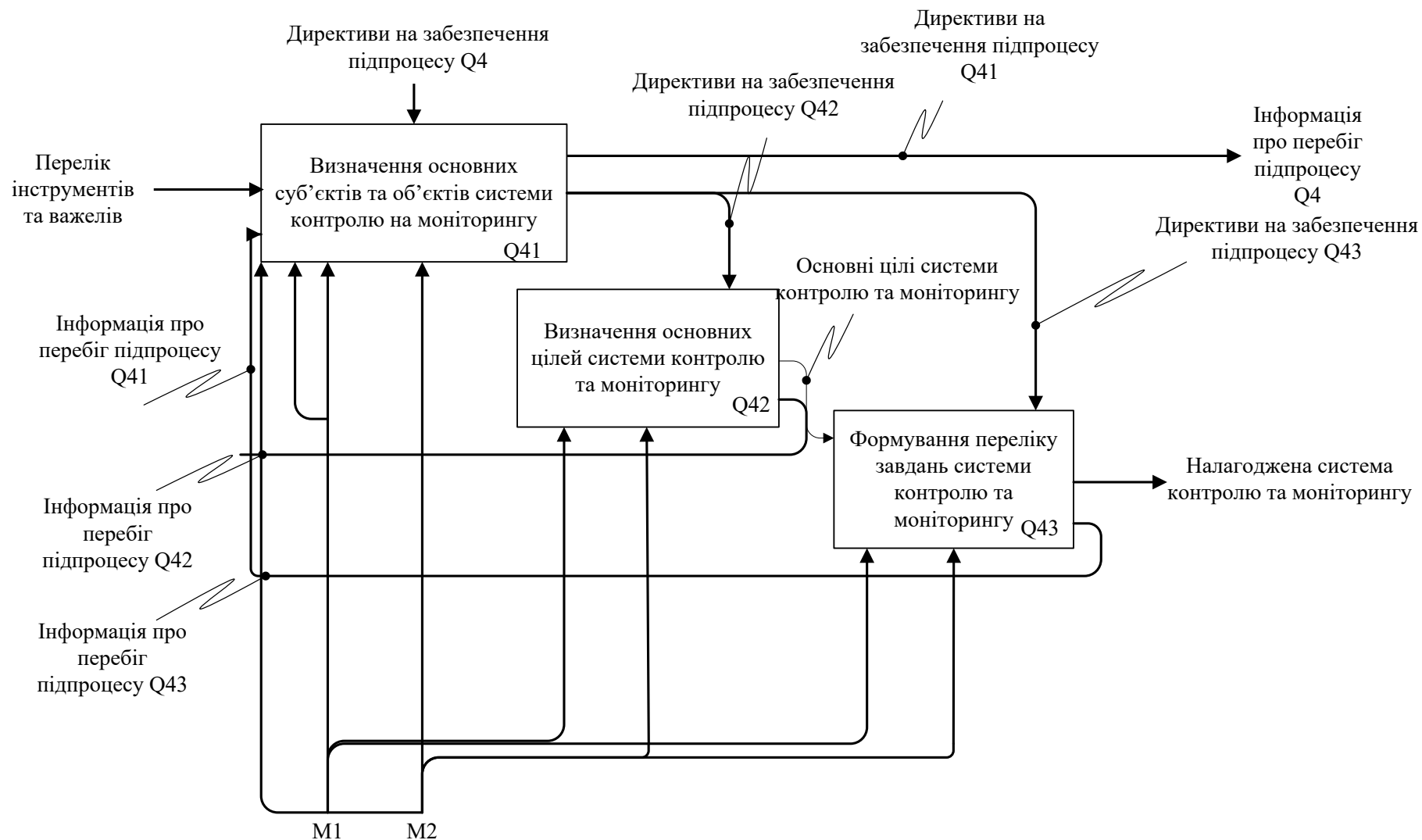
Рис.3.7. Основні етапи досягнення рівня Q4 згідно техніки моделювання через IDEF0
