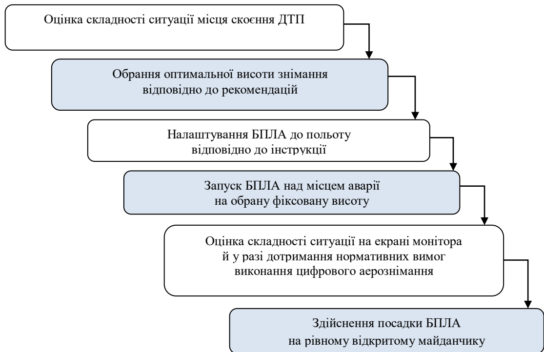
Рис. 3.2. Етапи роботи з БПЛА для фіксації ДТП, розроблено авторкою за матеріалами джерела [5, с. 163]
